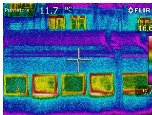
Figura 4.8 – Rilievo termografico dei serramenti esterni in alluminio e vetrocamera
